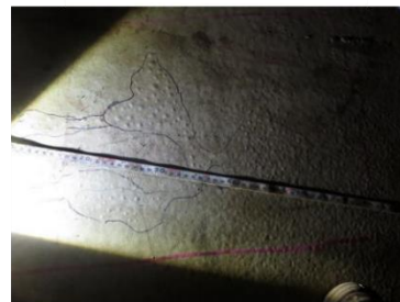
図 82 コーティングの膨れの影響（エコー高さ、外観、板厚、塗膜厚さ）
