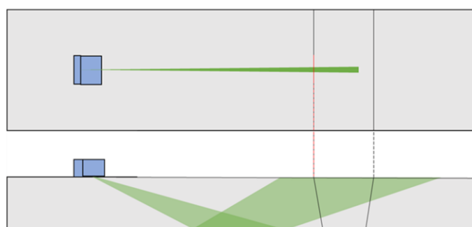
図2 本検討の超音波の発信方向のイメージ図
